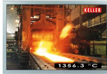
En dammig och rökig miljö försvagar informationen pyrometern får. Genom att använda en tvåfärgspyrometer krävs mindre ljus vilket möjliggör en mätning.
